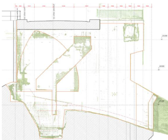
Obr. 5 Příklad vyhodnocení bourání kombinací 3D modelu a laser scanu – zřejmá zelená místa lokalit s nedostatečnou hloubkou bourání
