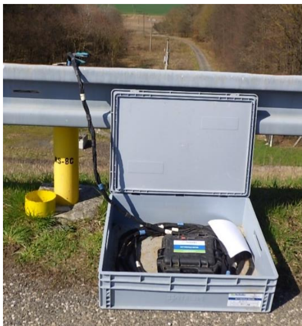
Obr. 1 Prístroj ECT Profile Meter osadený vo vrte
