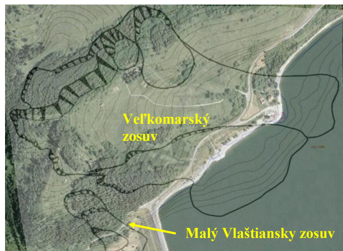
Obr. 1 Situovanie priehradného profilu VS Liptovská Mara medzi Veľkomarský a Malý Vlaštiansky zosuv (situácia – Google Earth)
