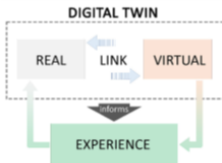
Obr. 1 Vizualizace principu technologie digitálního dvojčete [1]
