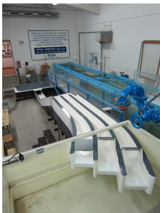
Obr.1 Fyzikální model doplňkového bezpečnostního přelivu se třemi poli hrazenými segmentovými uzávěry
