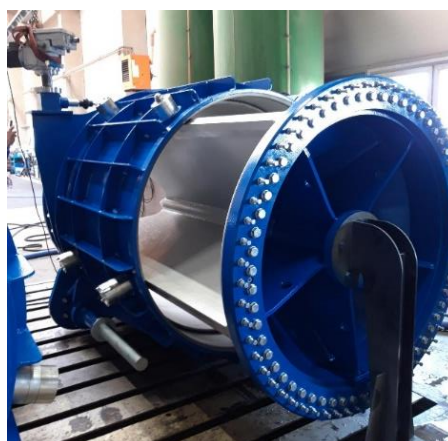
Obr. 7 Model uzávěru (AQUATIS a.s., 2020) Obr. 8 Dílenské práce na rozstřikovacím uzávěru (Ševčík HYDRO s.r.o.)
