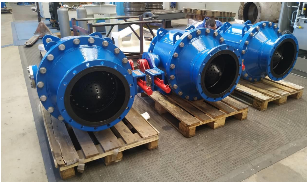
Obr. 6 Dokončené kuželové uzávěry (Ševčík HYDRO s.r.o.)
